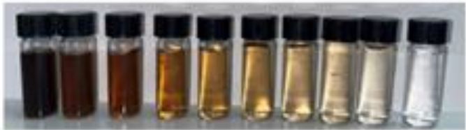
Рисунок 18 – Пробы гидрогелей в дистиллированной воде с высвобождением гуминовой кислоты из гидрогеля во времени
